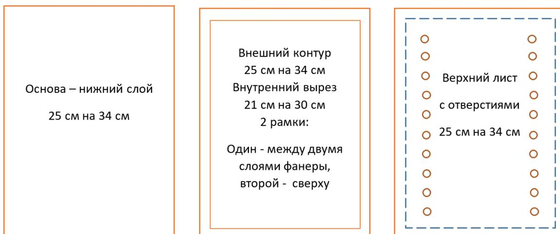
2. На втором прямоугольнике нужно сделать 20 отверстий для доступа к площадкам из фольги. Отверстия должны быть размещены так, чтобы
